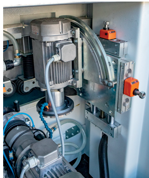
MULTIFUNCTION SPINDLES Grupo multicorte con rotación 0/90
